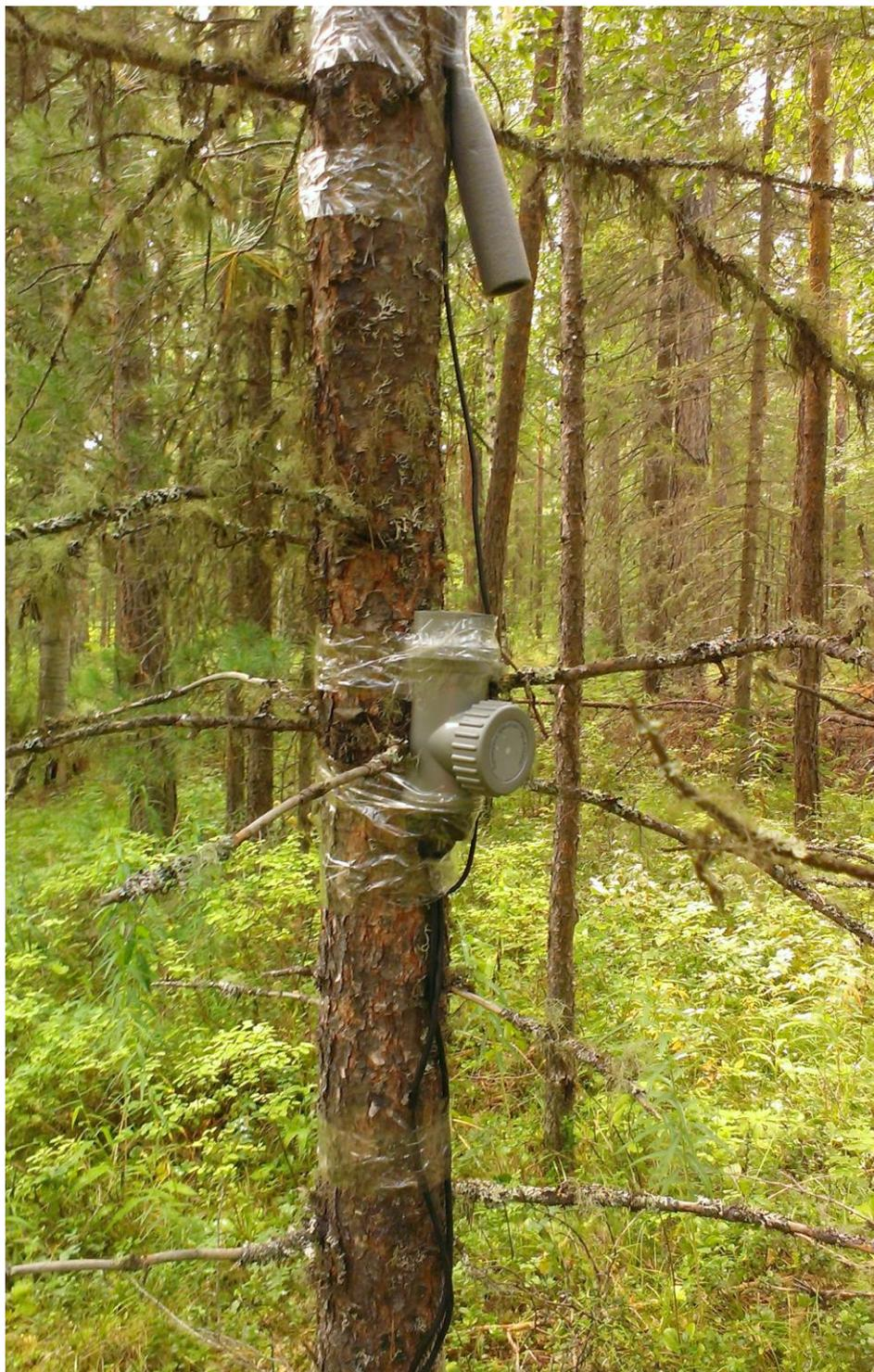
Рис. 5.6. Автоматический прибор для сбора данных по температуре воздуха и почвы (логгер), установленный в предгорной части долины р. Давше (12,5 км от побережья оз. Байкал). Фото С.Н. Куракова, 2017 г.
