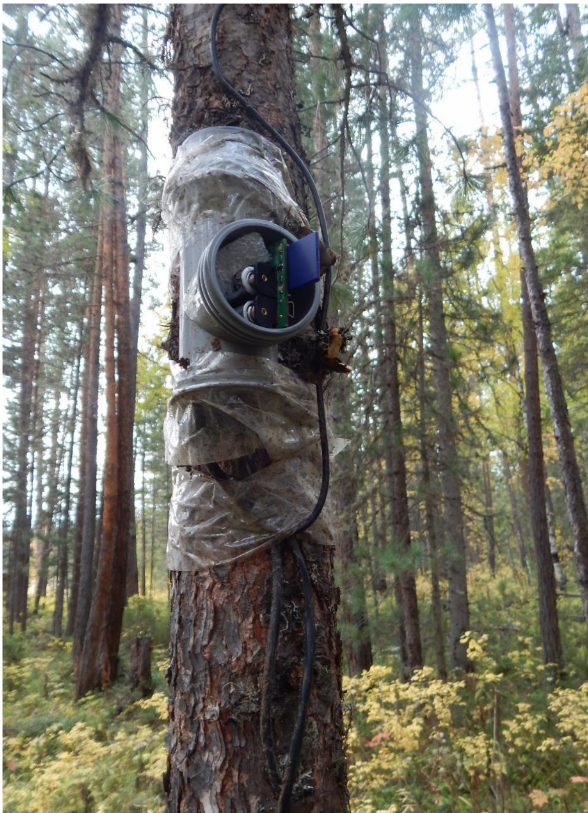
Рис. 5.6. Считывание метеорологической информации с автоматического логгера, долина р. Давша. Фото Т.Л. Ананиной, 2018 г.
